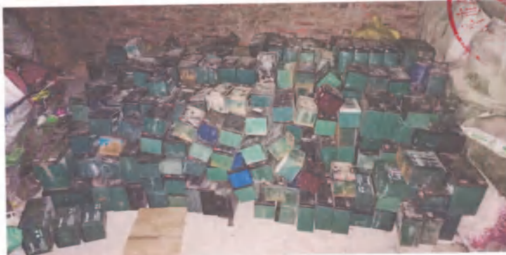
图为 2022 年 1 月 7 日，南平市邵武生态环境保护综合执法大队人员到位于邵武市林业开发区水库饲料仓库现场检查时，发现该仓库内堆放有一堆废旧铅酸蓄电池。该废旧铅酸蓄电池贮存场所未采取有防止废铅蓄电池破损和电解质泄漏及有耐腐蚀包装容器等国家环境保护标准的防护措施。
