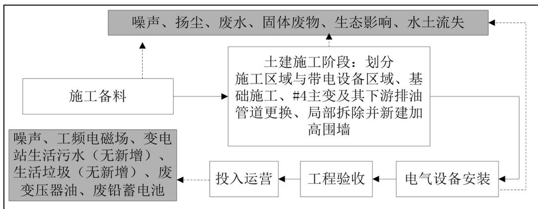
图 3.1-6 项目施工工序流程及产污环节图
