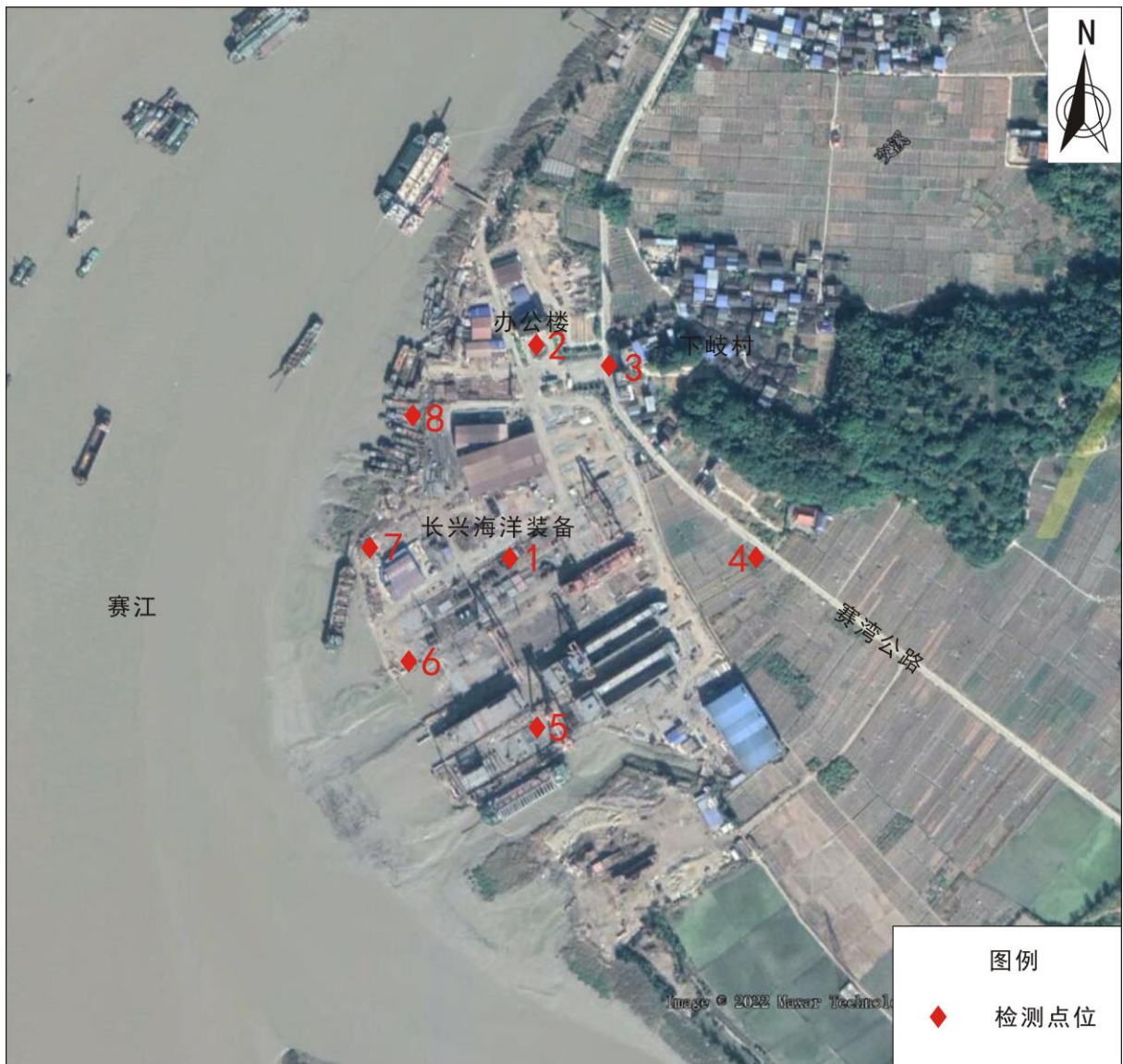
图 8-2 长兴海洋装备厂区及周边辐射水平背景值监测点位示意图
