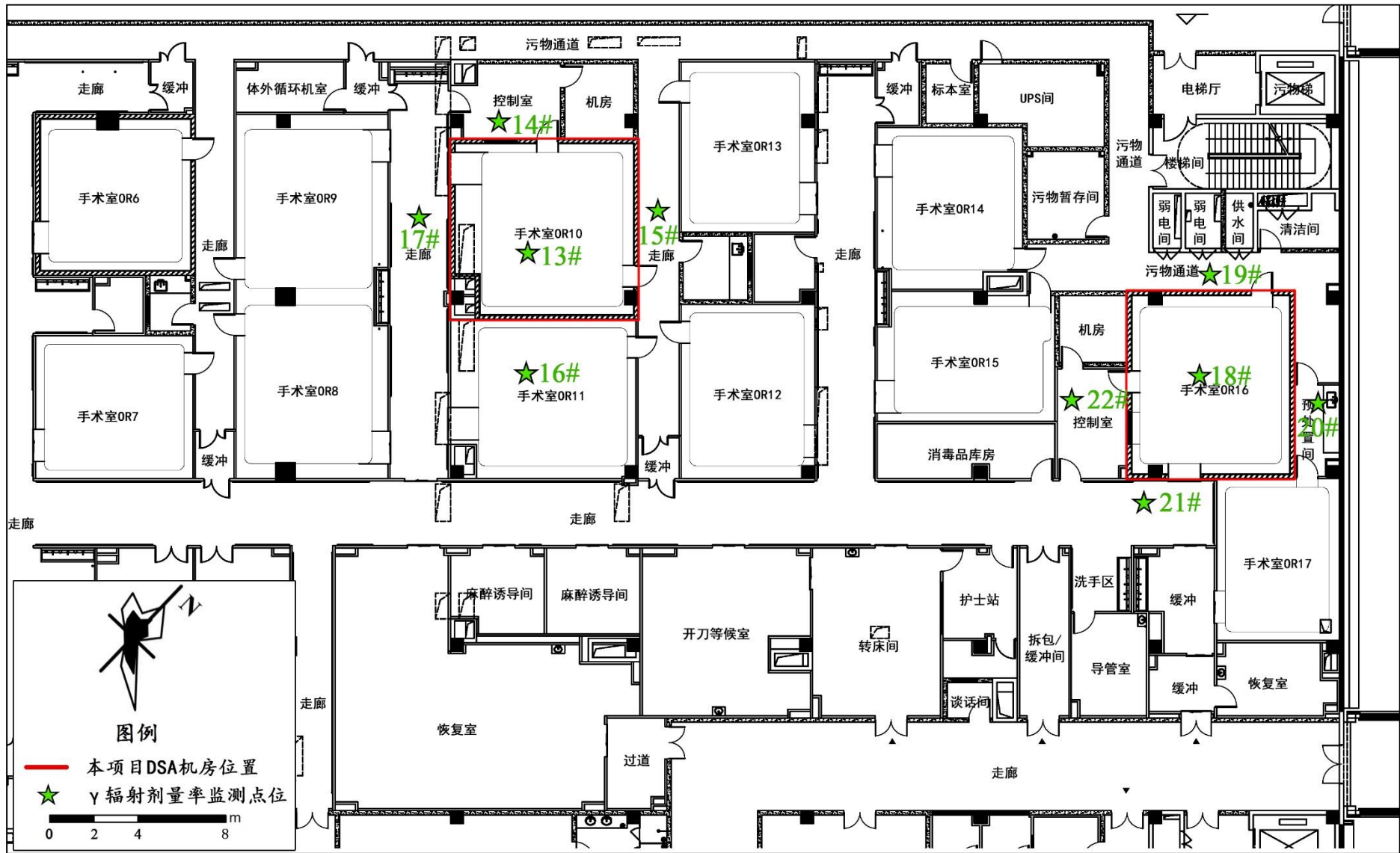
图 8.2-4 医技及门急诊楼（二期）3 楼 \gamma 辐射剂量率监测点位图（DSA 机房处）
