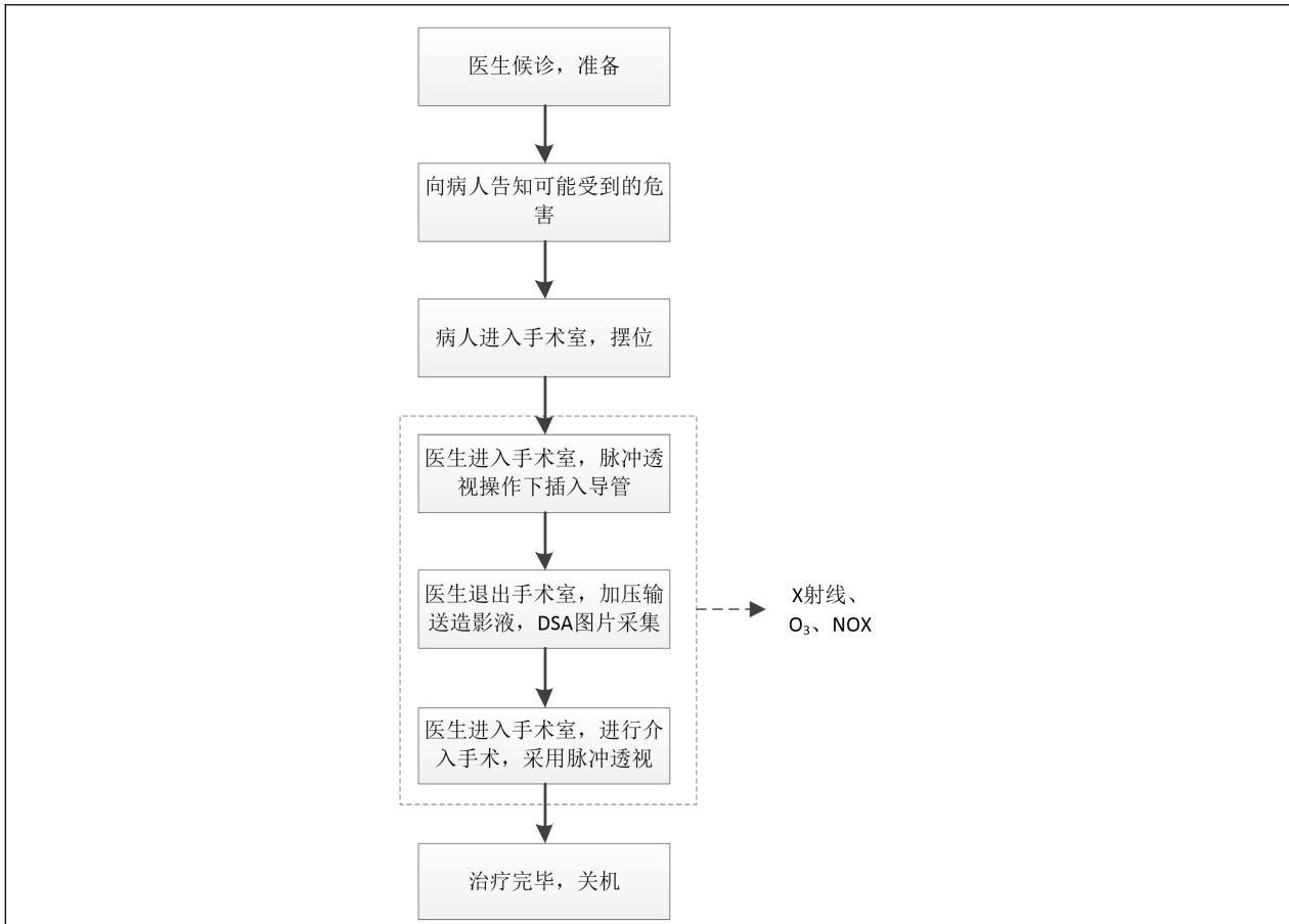
图 9.1-3 DSA 机工作流程图及产污环节
