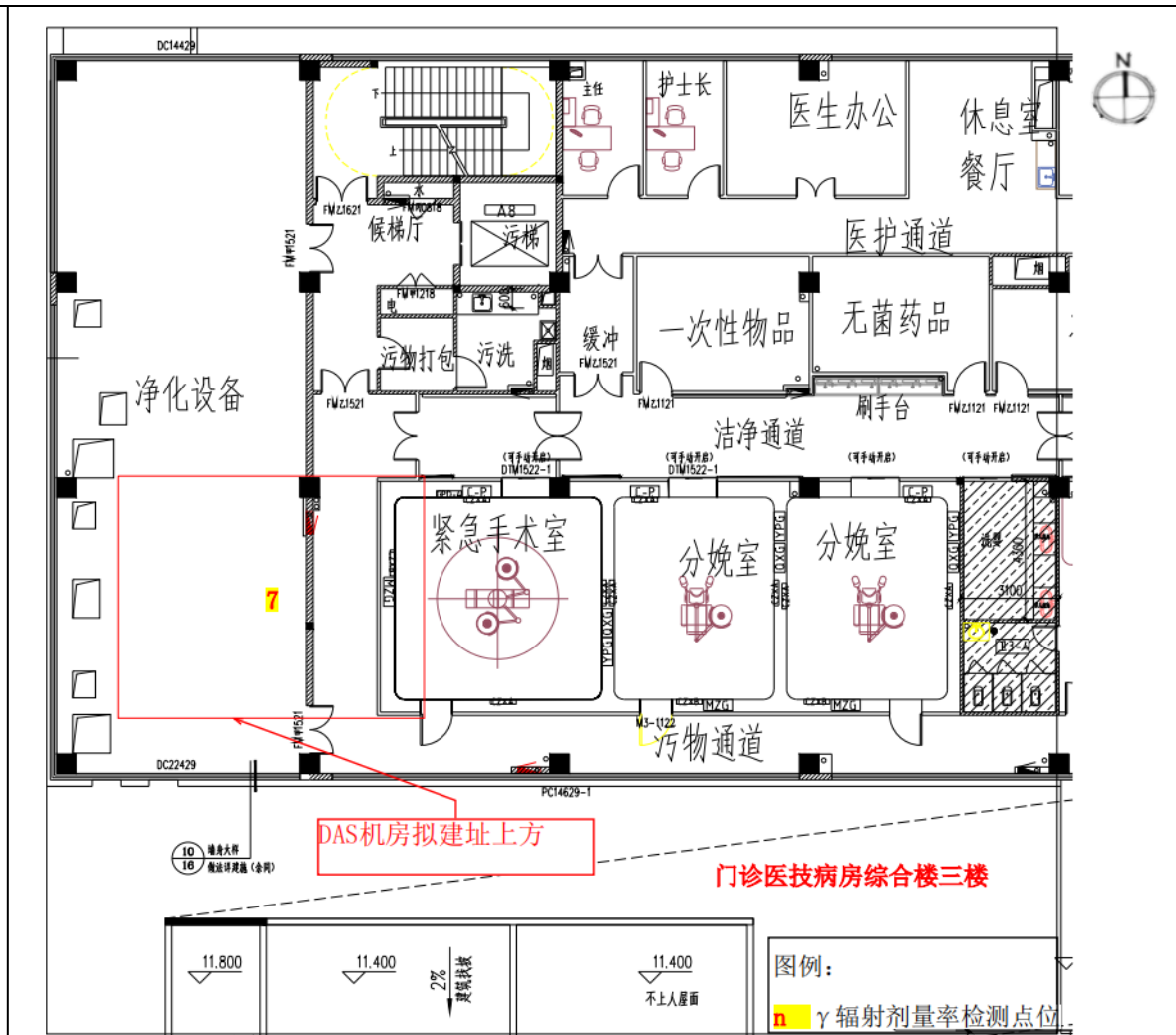
图 8-2 本项目 DSA 机房拟建址及周围环境本底检测点位图 (二)
