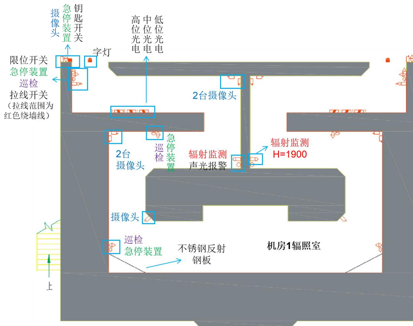
图10-4 本项目电子加速器机房辐照防护连锁图（辐照室）
