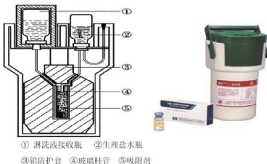
图9-3 钼锝发生器结构示意图
