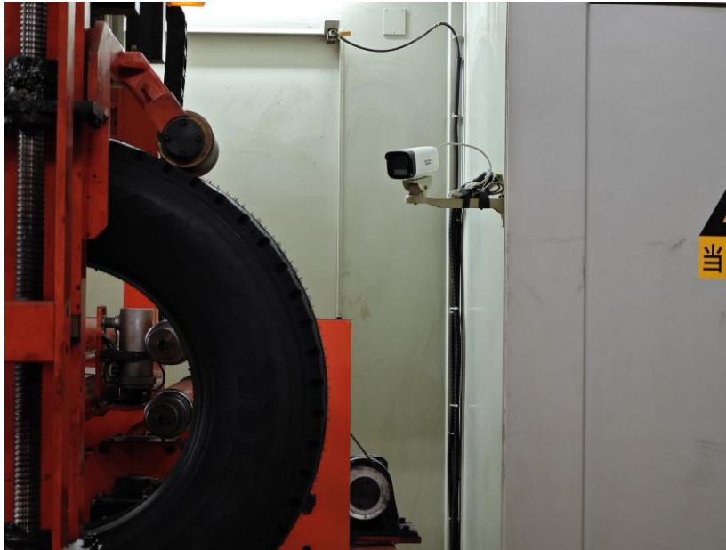
图 10-3 载重轮胎 X 射线检验机内部视频监控摄像头位置
