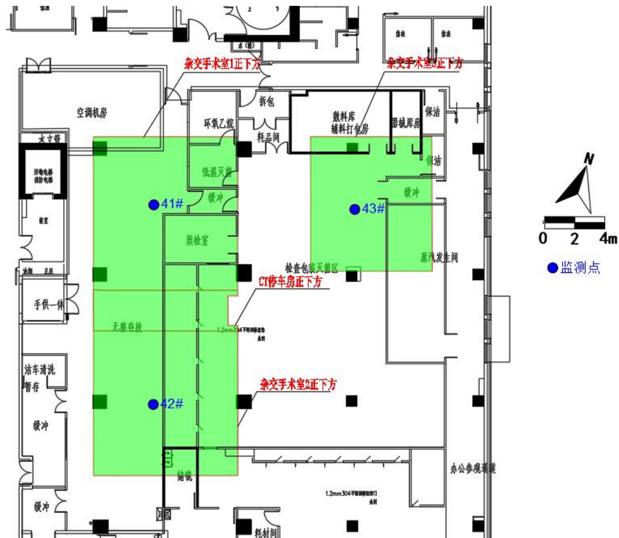
图 8.2-8 本项目杂交手术室下方辐射环境检测布点图（二层）
