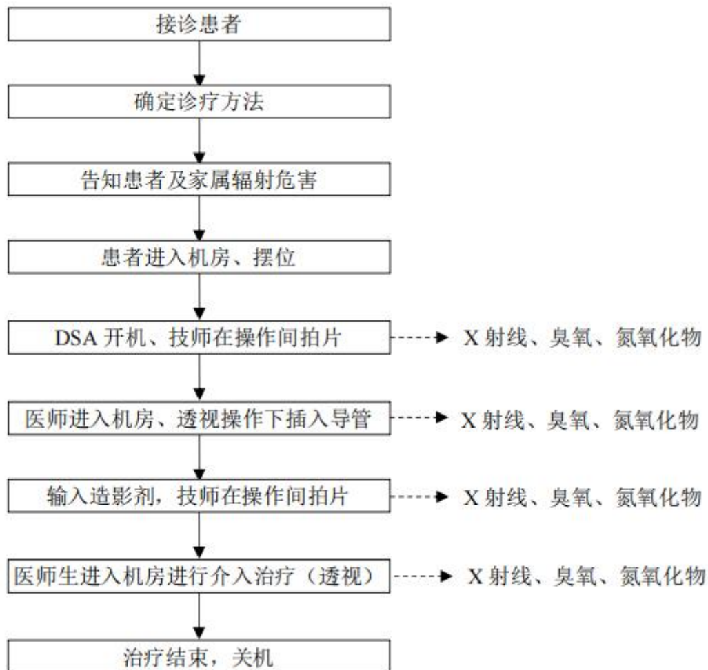
图 9-2 DSA 机工作流程及产污环节示意图
