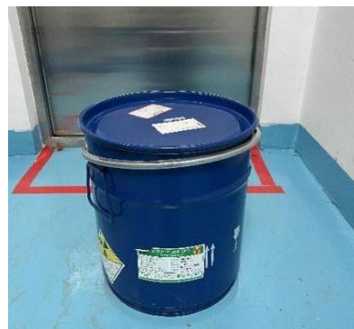
放射性核素货包外包装（运输钢桶）示意图
