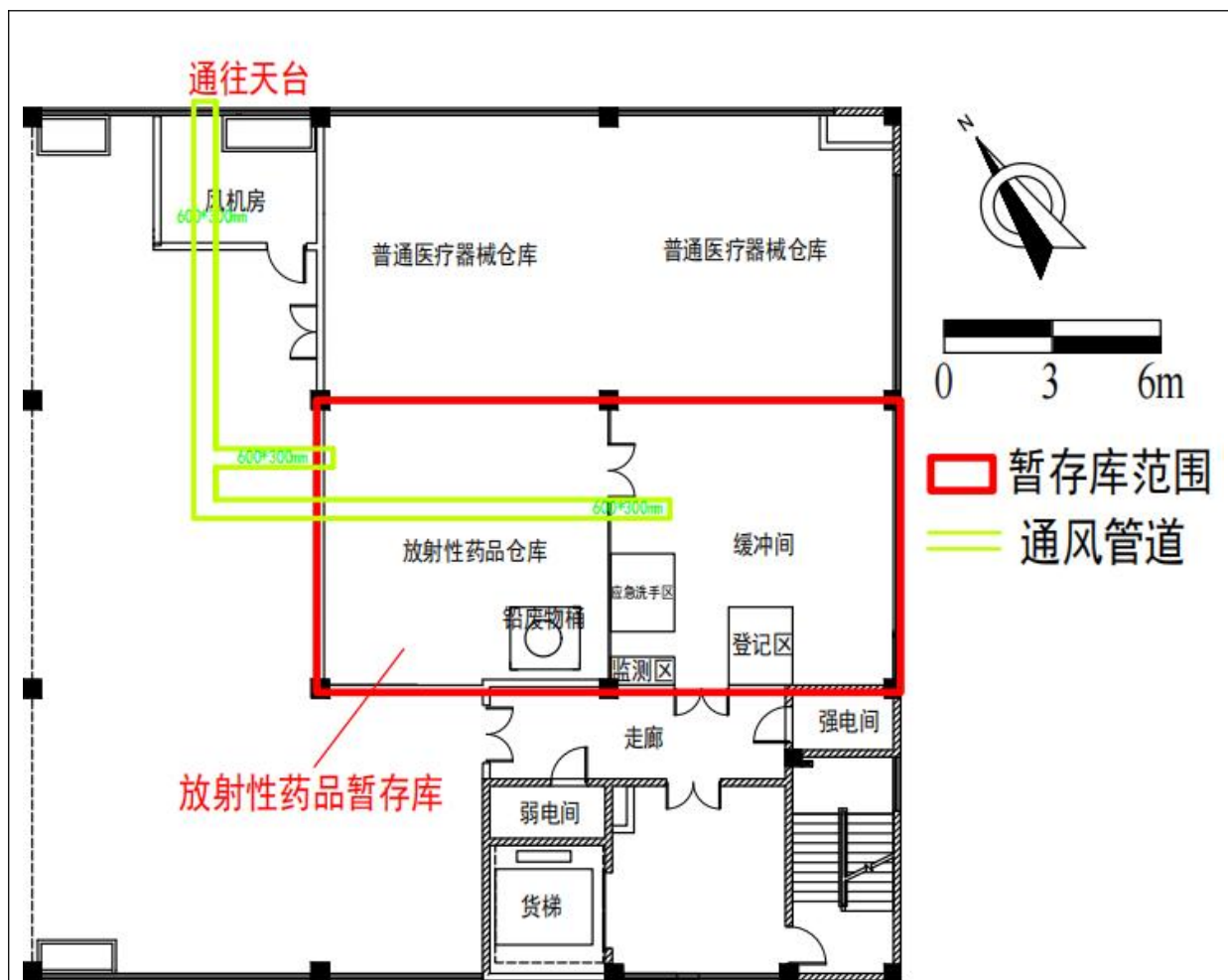
图 10.3-1 通风管道示意图
