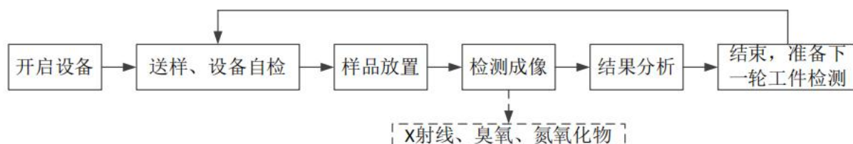
图 9-3 项目 X 射线数字成像系统工作流程及产污环节示意图
