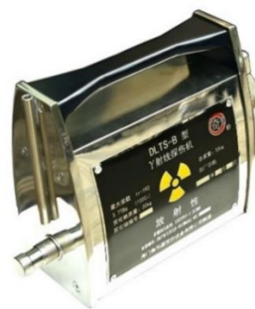
图 9-3 典型 ^{192}\text{Ir} - \gamma 射线探伤机外观图
