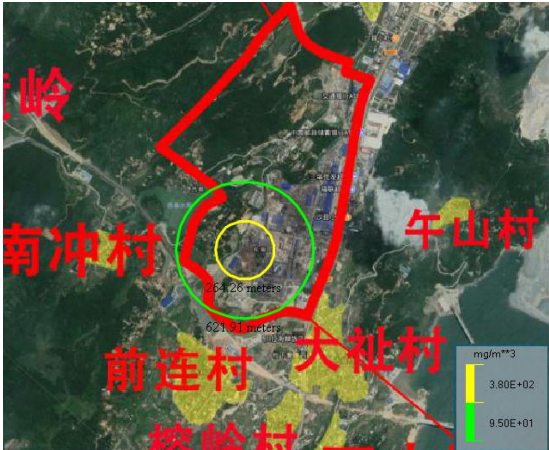
图 9.6-6 最常见气象条件下 CO 达到不同毒性终点浓度的最大影响范围图
