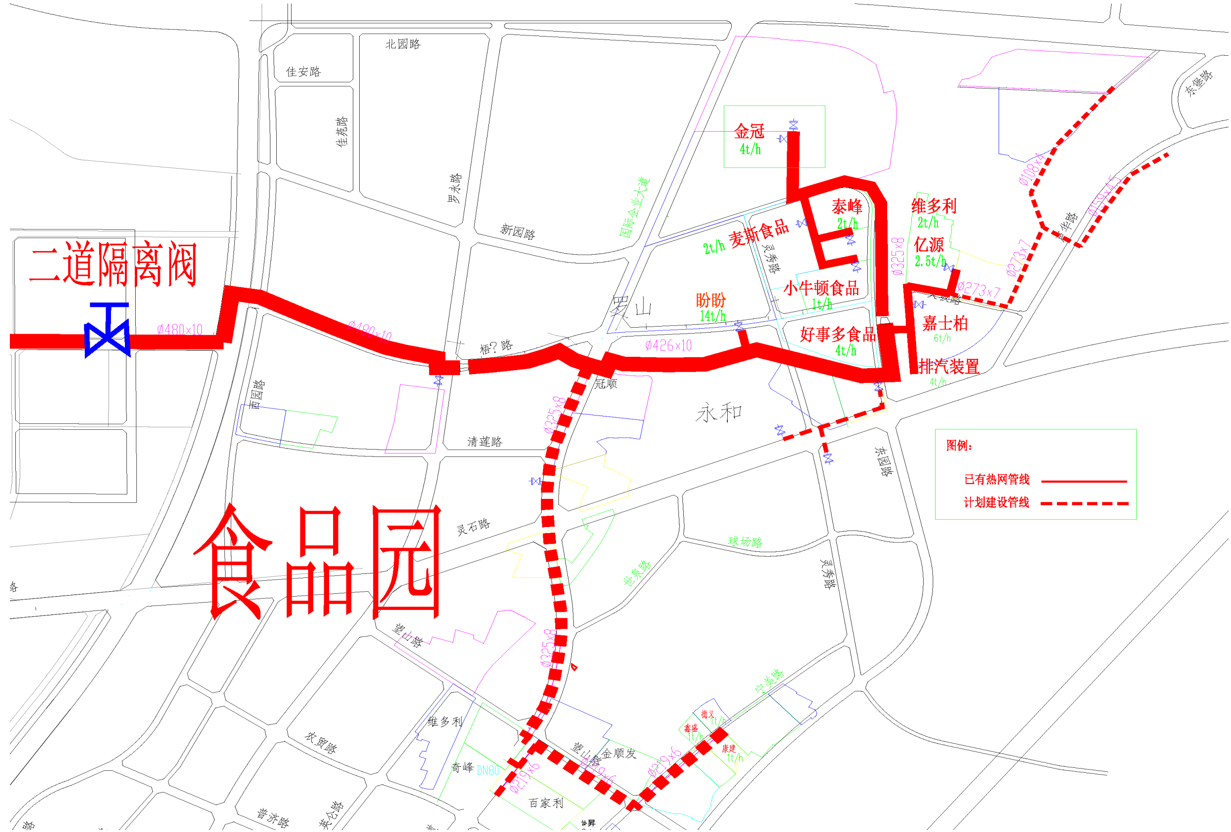
图 3.5-11 规划的供热管线具体走向（食品园新增）
