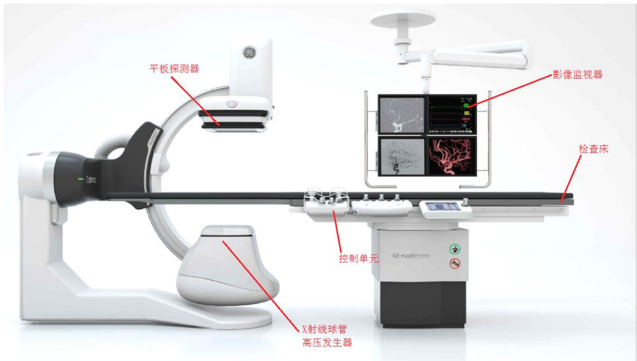
图 9-1 典型 DSA 外观结构图
