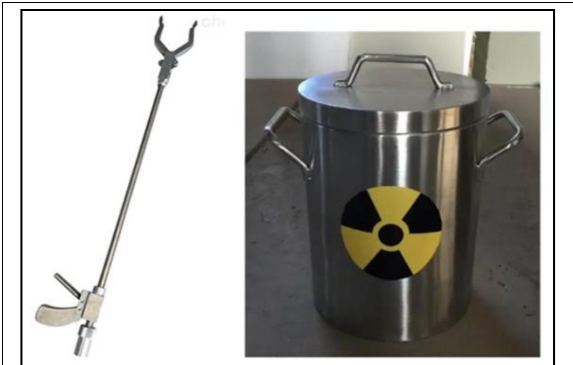
图 10.1-2 长柄钳、贮源容器外观图
