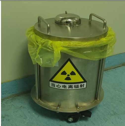
1 号楼一层核医学科高活性室铅衰变桶
