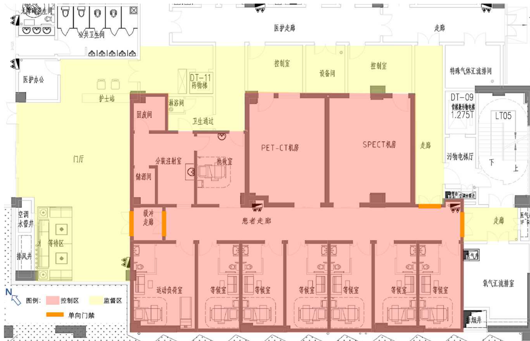
图 4-83 核素诊断区辐射工作场所分区图
