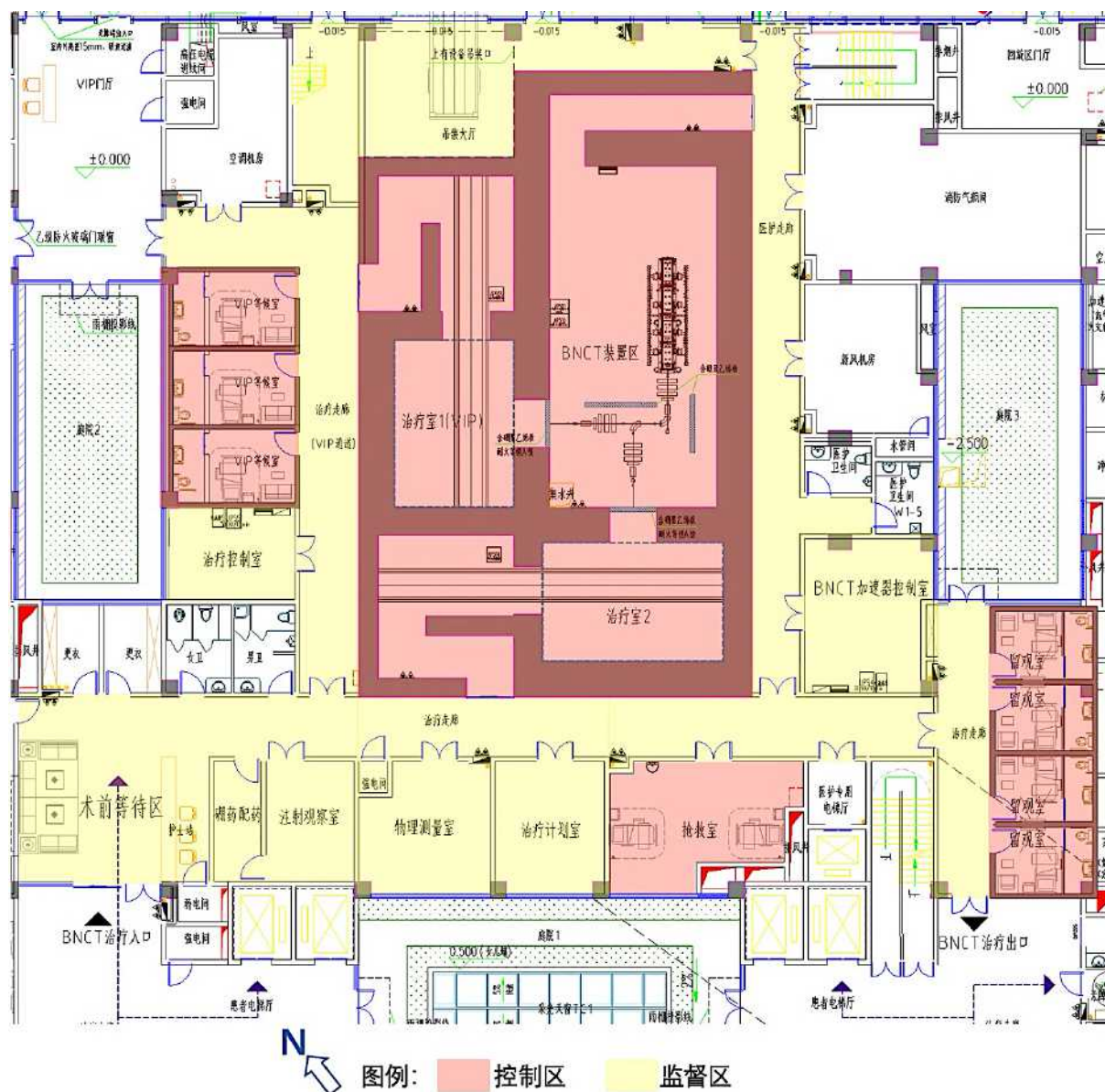
图 4-30 硼中子治疗辐射工作场所分区图（一层）
