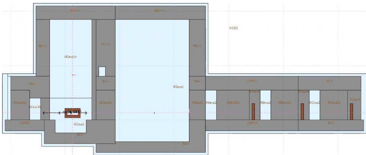
图 5-3 质子治疗系统屏蔽模拟计算模型南北向剖面图
