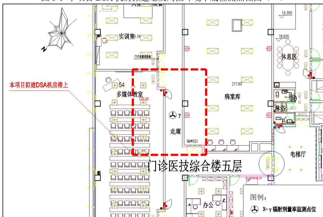
图 8-2 本项目 DSA 机房拟建址及周围环境本底检测点位图（二）
