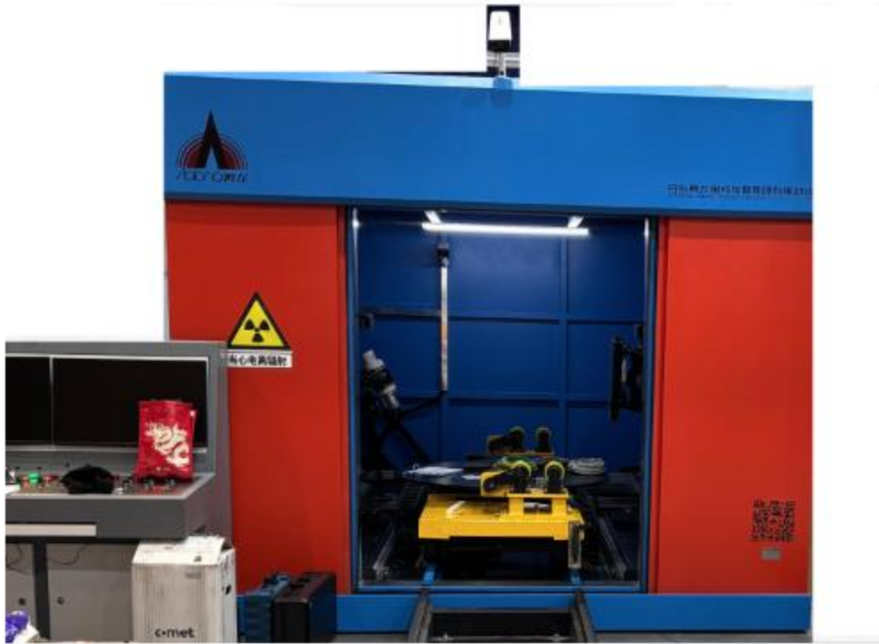
图 9-2 XYG-22508/3 型 X 射线数字成像检测系统外观图
