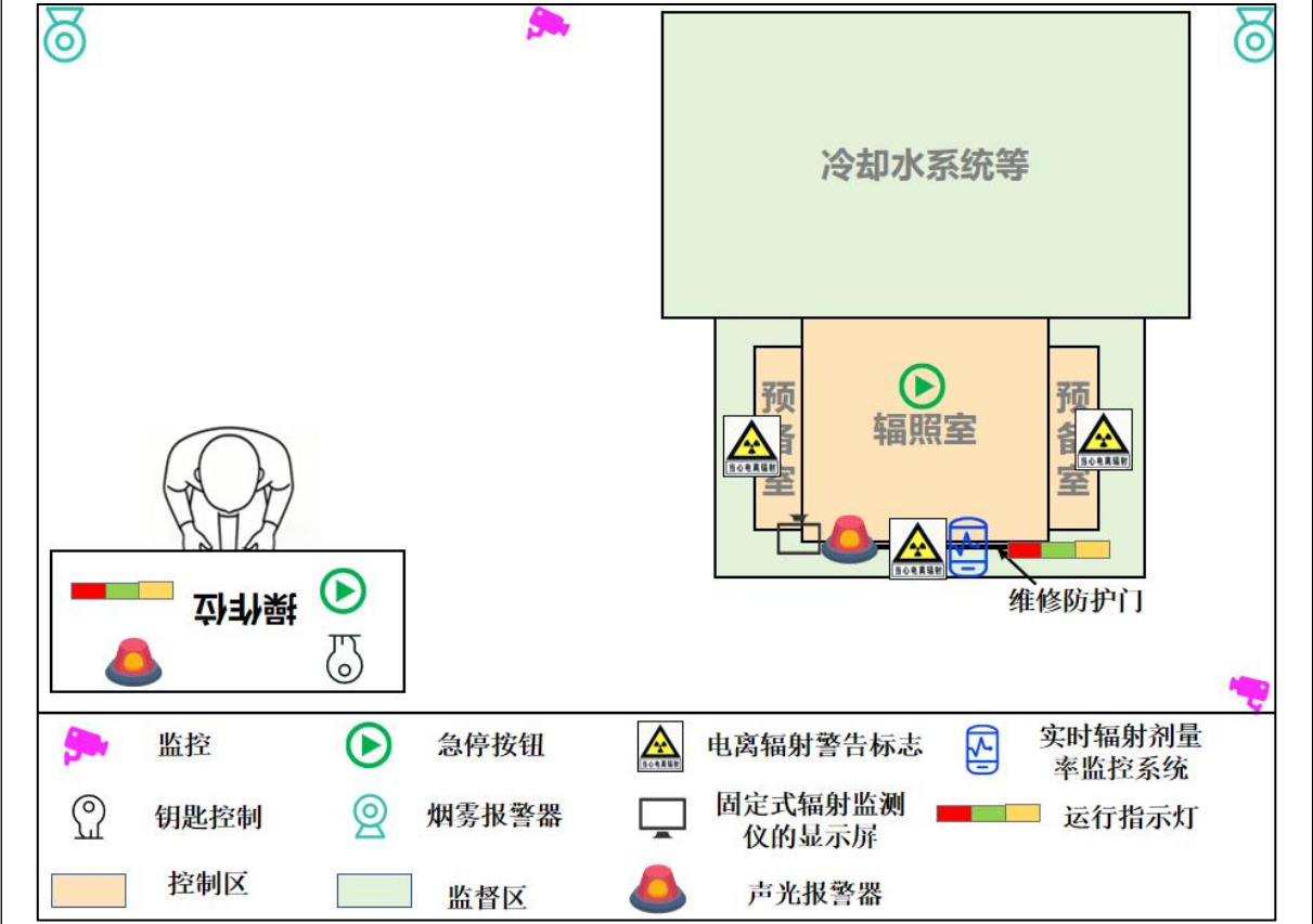
图 10.3-16 半钢自屏蔽加速器辐射安全设施布置示意图
