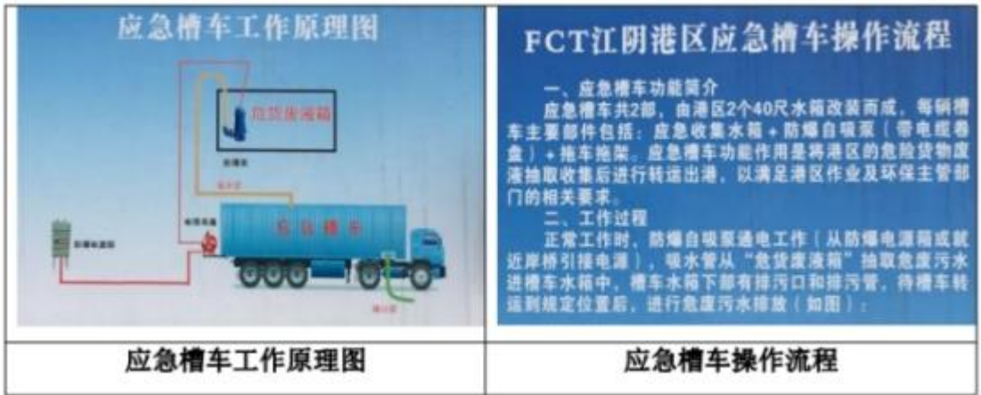
图 3.6-6 应急槽车工作原理及操作流程
